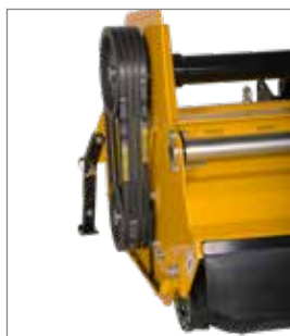
Vitesse de rotation de l'arbre de prise de force de 540 ou 1.000 tr/min possible sur les MU-L Vario 180-250.
