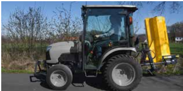
Conception courte pour un centre de gravité au plus près du tracteur.
