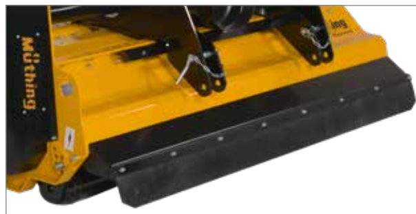
Le pare-poussière pour véhicules porteurs empêche toute entrave à la visibilité de même qu'un encrassement excessif des points d'aspiration surbaissés par la poussière dégagée.
