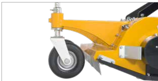
Des roues de support stables pour la montée à l'avant facilitent la manipulation et améliorent le suivi du sol (en option). Elles sont réglables en hauteur et pivotantes à 360°.
